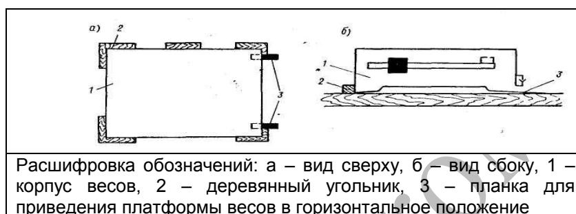
Рисунок 2 – Установка весов на дощатом основании будки
